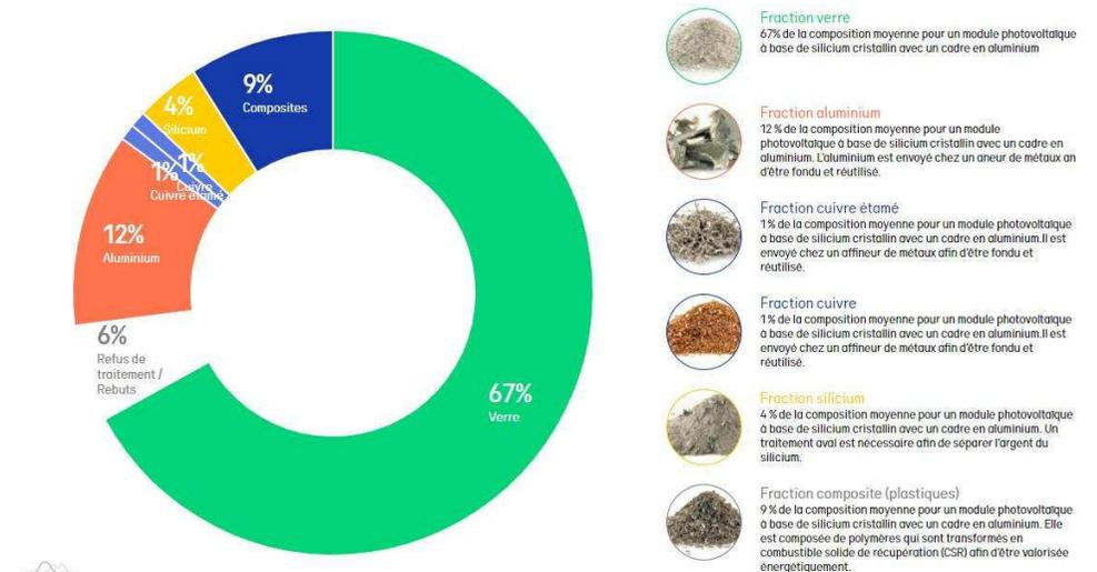
Illustration 32 : Répartition des différentes fractions composant un panneau solaire photovoltaïque (Source : Soren)
